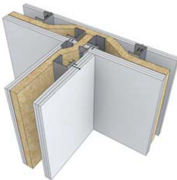
Figure 9 : Schéma de raccords de cloisons en T entre deux cloisons séparatives (Source : Guide de suivi de la mise en œuvre en acoustique dans le logement neuf CSTB)
